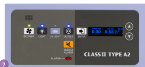
Il pannello di controllo a microprocessore offre una supervisione costante di tutte le funzioni della cabina. I pulsanti softkey con icone universali permettono di gestire con una sola mano l'accensione/lo spegnimento e il sistema di allarme/monitoraggio.
